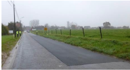
Фигура 8 40 м тестов участък в Белгия, на който е положена пороеластична настилка.
