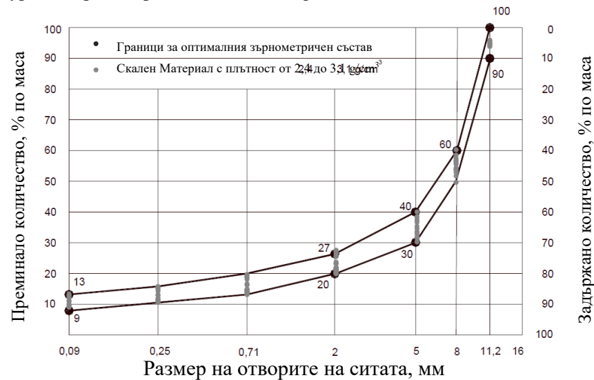
Фигура 4: Граници за оптималния зърнометричен състав SMA 11 S
