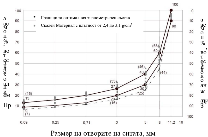
Фигура 4: Граници за оптималния зърнометричен състав SMA 11 S
